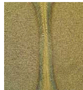
รูปที่ 3 แสดงโครงสร้างจุลภาคบริเวณรอยเชื่อมของวิธี ERW 1
